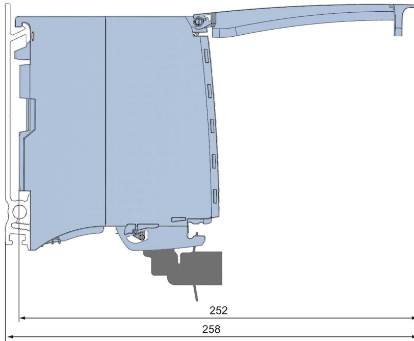
Bild A-2 Maßbild des Moduls AQ 4xU/I ST in Seitenansicht mit geöffneter Frontklappe
